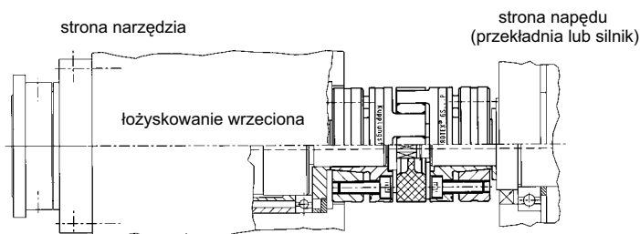
ROTEX GS wykonanie P z centralnym doprowadzeniem środka chłodniczego do głowicy wrzeciona krótko-otworowego lub głowicy wielowrzecionowej
